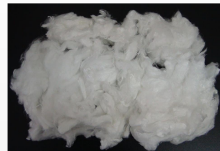
开孔后的多微孔涤纶纤维
