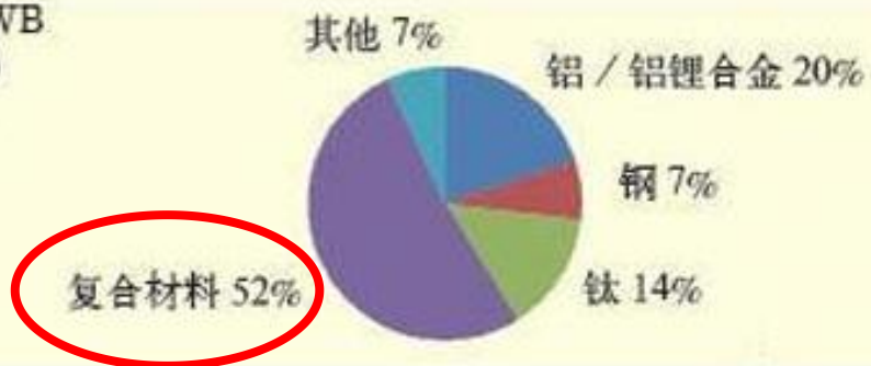
A350飞机的材料比例
