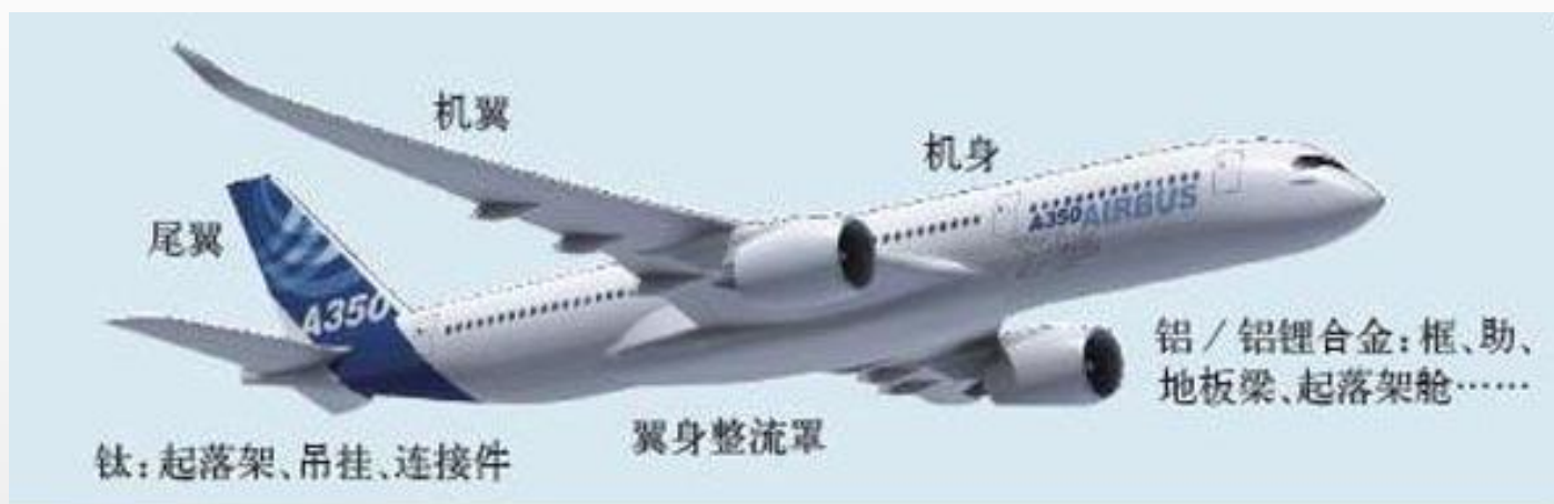
A350-900XWB 材料分析 (%) 包括起落架
