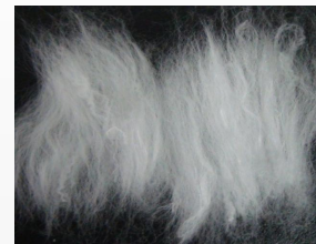
开孔后的多微孔涤纶纤维
